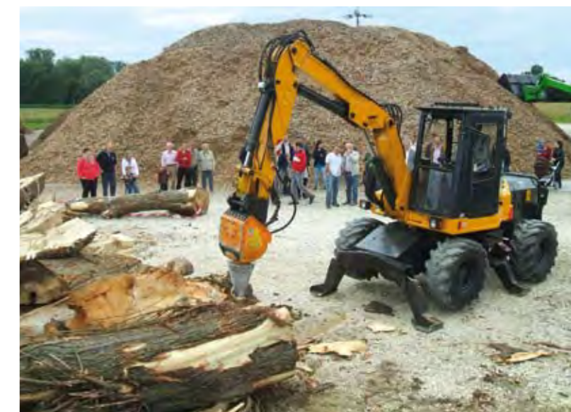
Die Zuschauer sind beeindruckt: Das Schneckenaggregat des Kegelspalters wird auch mit extrem dicken Stämmen fertig.
